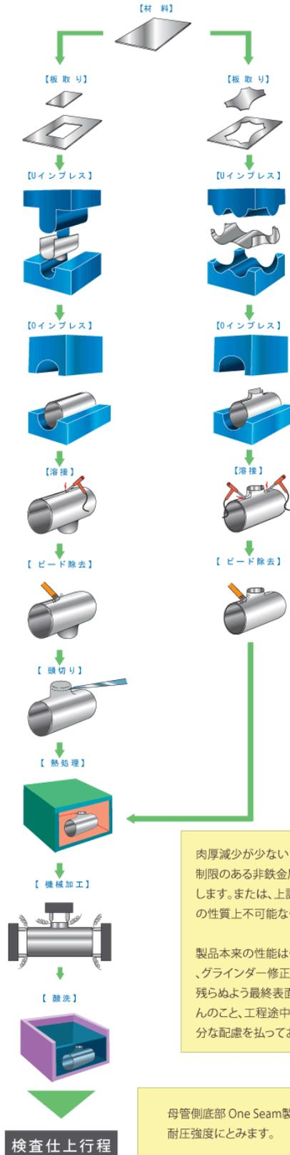
肉厚減少が少ないため、使用板厚に制限のある非鉄金属高級合金等に適用します。または、上記製法がその金属の性質上不可能なものに適用します。
